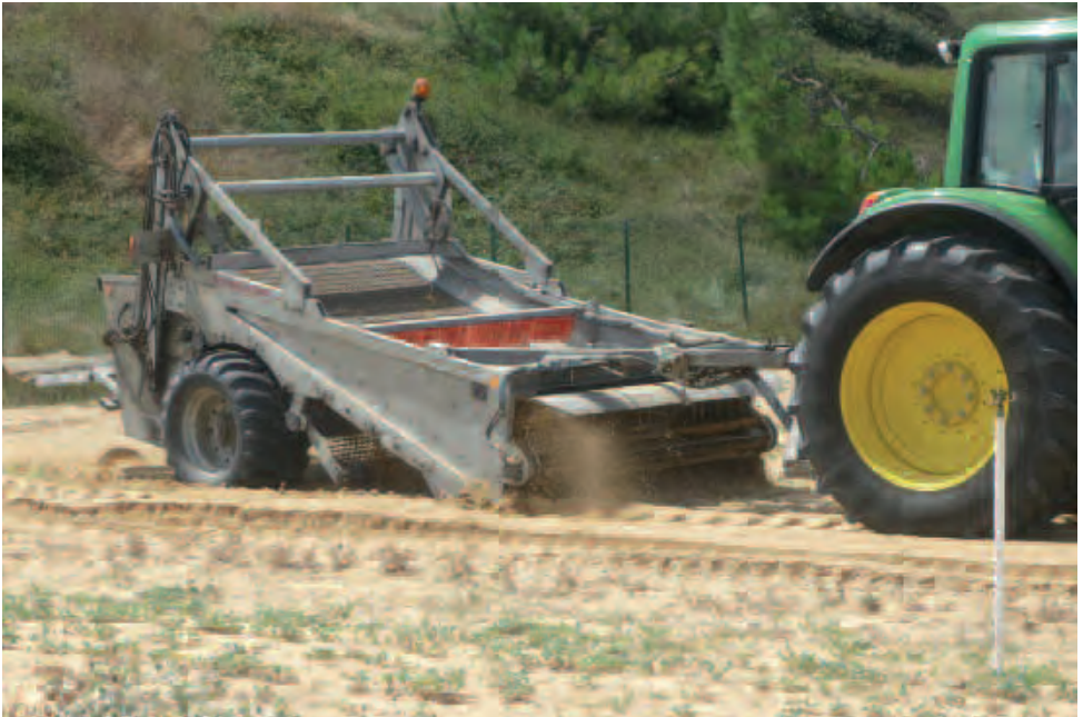
Photo 6.24 Système utilisé pour nettoyer le sable. © Carlos Ley
