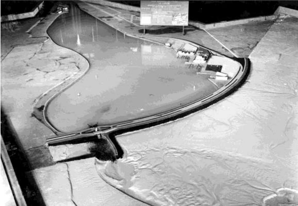
Photo ci-dessus : vue d'ensemble du projet reconstitué au sein du Laboratoire National d'Hydraulique
