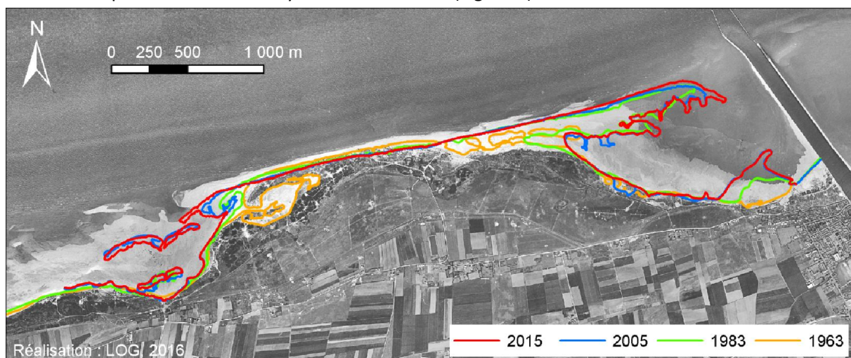
Figure 3 : Evolution du trait de côte de 1949 à 2015 d'après des photographies aériennes ortho-rectifiées. Traits de côte superposés à la photographie aérienne de 1949 ortho-rectifiée par l'IGN.
