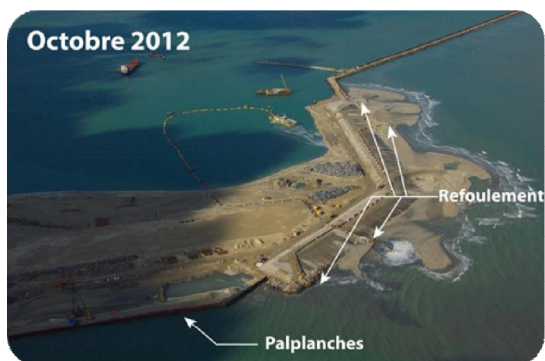
Figure 9 : Photographie aérienne du refoulement de sable au droit de la digue du Ruytingen (GPMD, 2012)
