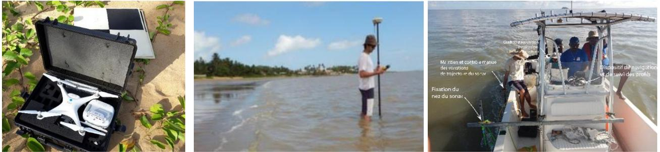
Figure 1 : Comparaison Drone Phantom 4 (à gauche), DGPS (au centre) et sonar à balayage latéral (à droite) utilisés respectivement pour la photogrammétrie, les levés topographiques et la cartographie de la nature des fonds
