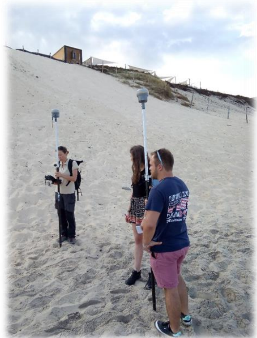
Photo 2 : séance de mesures au GPS différentiel pour réaliser des profils de plage, avec l'Observatoire de la Côte Nouvelle Aquitaine (OCNA), juillet 2020, ©CCGL
