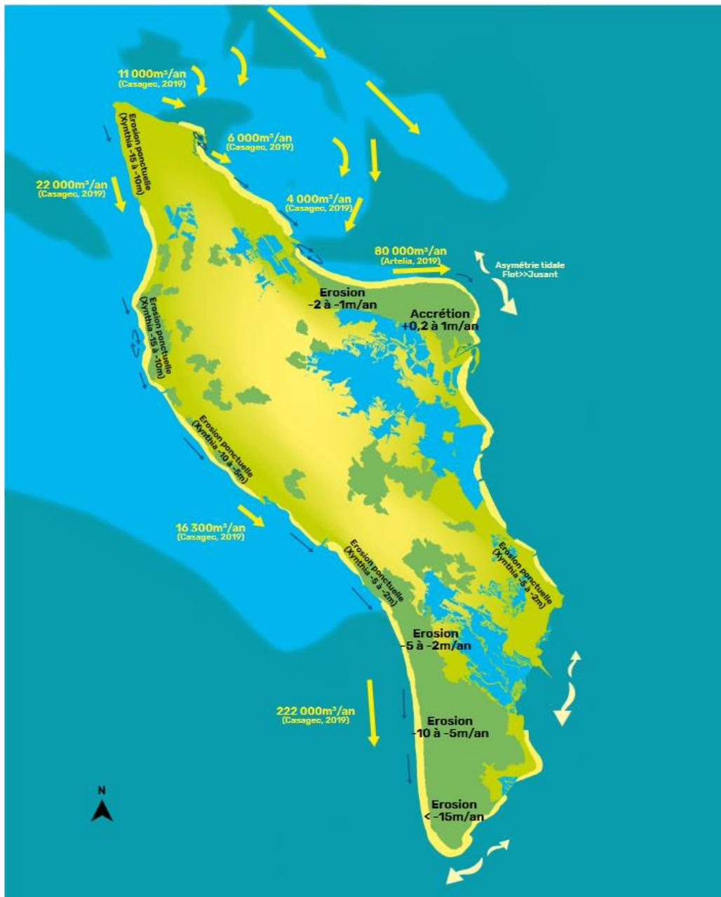
Fig. 1 - Schéma de fonctionnement des cellules hydrosédimentaires de l'île d'Oléron
