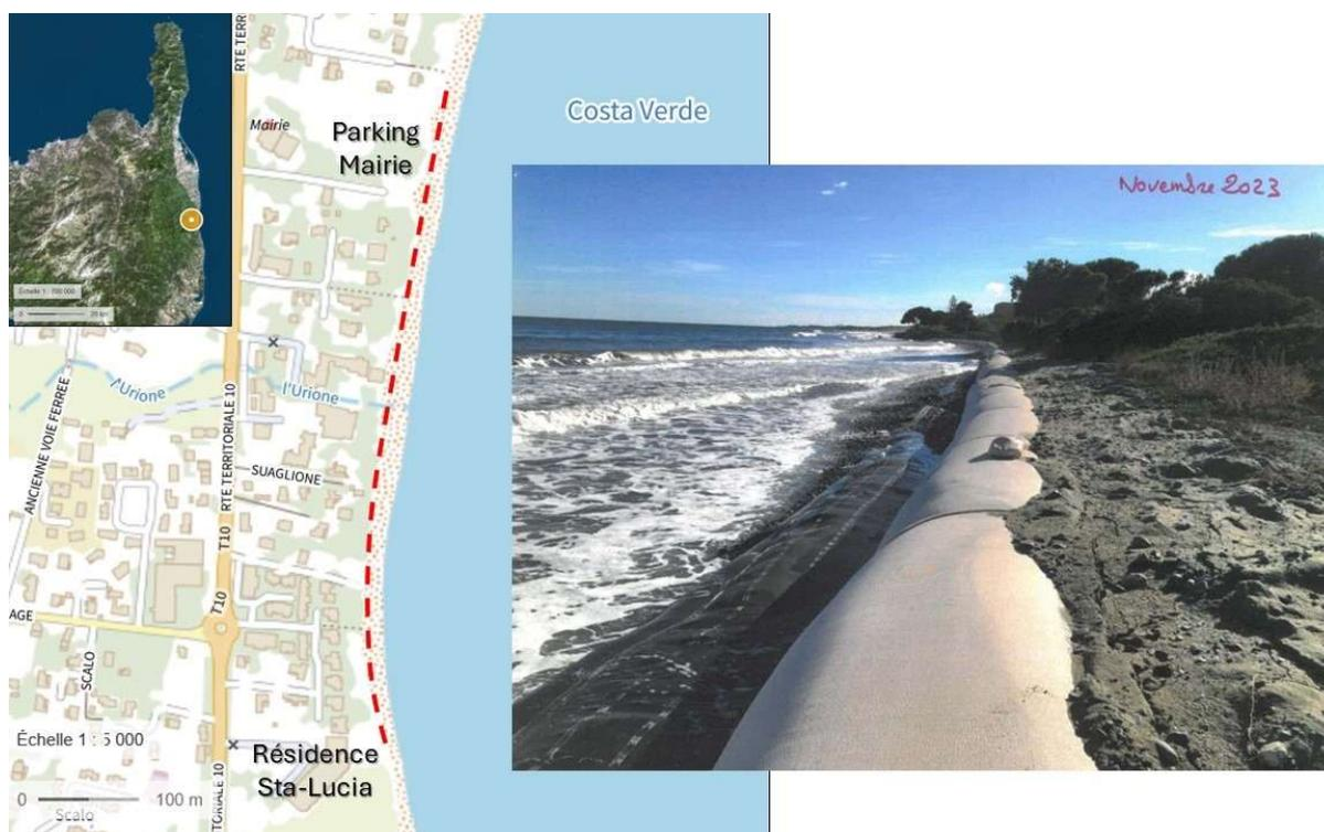
**Figure 69 : Localisation du système de géotubes (pointillés rouges) sur fond de carte Géoportail (©IGN) et image des géotubes et du tapis anti-affouillement à droite (©CCCV, novembre 2023).**
