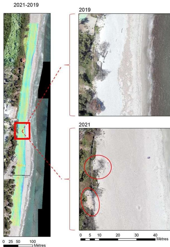
Figure 60 : Exemple(s) d'évolution morphologique sur le secteur de Cap-Sud entre 2019 et 2021 : élargissement et engraissement de la plage, progradation du trait de côte, apports éoliens et piégeage de sable en arrière-plage
