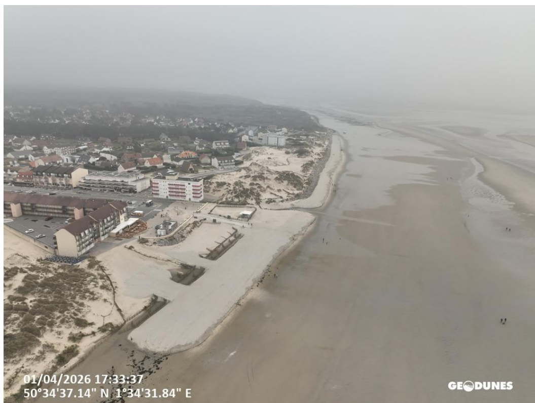
Figure 7. Front de mer de Sainte-Cécile après le rechargement d'environ 10 000 m 3 de sable réalisé par la CA2BM du 24 au 27 mars 2026. Photographie du 1er avril 2026. Source : Géodunes ; CA2BM.
